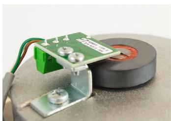
LIVI/X est un automatisme précis et sûr, équipé d'un système de détection de la course à l'aide d'un encodeur magnétique ou numérique. La platine commande le mouvement du portail, détecte la présence d'obstacles, rendant ainsi le portail encore plus fiable
