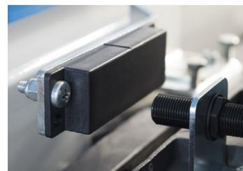
Interrupteur de fin de course magnétique permettant le calibrage de la course en plaçant les aimants de la crémaillère aux points de fin de course d'ouverture et de fermeture. Aucun problème en cas de neige ou de verglas !
